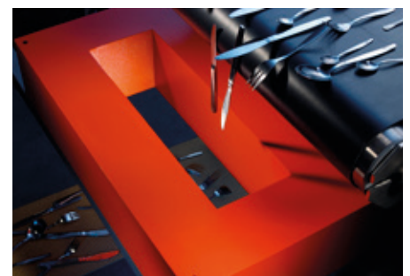
Falltunnel zum Entmagnetisieren von z.B. Besteck.
