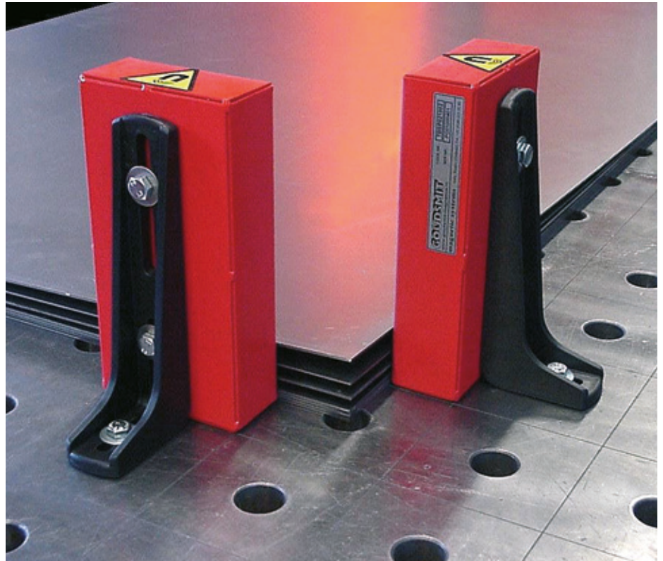
Permanente, nicht schaltbare Spreizmagnete in permanenter Ferrit- oder Neodym-Ausführung; Neodym ist 30% leistungsstärker und für Platten mit viel Öl auf begrenztem Raum geeignet.
