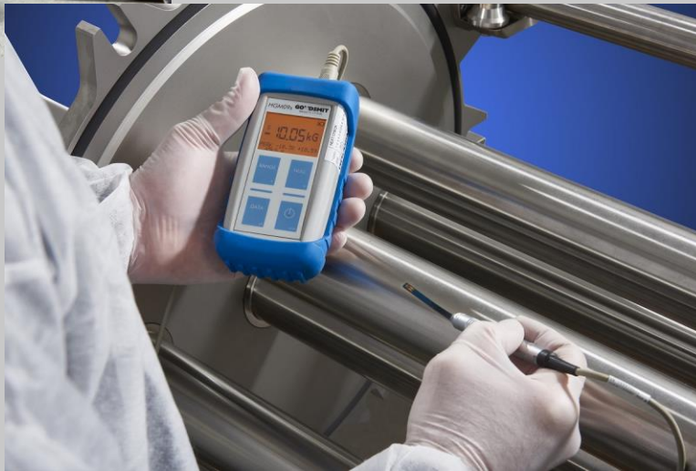
Плотномер магнитного потока (верхний левый) и его применение в системе магнитного разделения (нижний правый)
